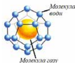
Рис. 1. Схематичне зображення структури газогідрату
